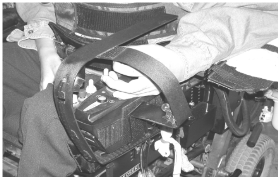
↑フレームを付けたところ。ジョイスティックの可動範囲に合わせて外側に広く、意外に幅をとる。
