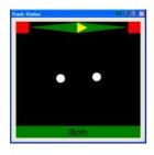
白い点がユーザーの『目』を表しています。 白い点が中心に出てくるようにモニターを 設置します。
